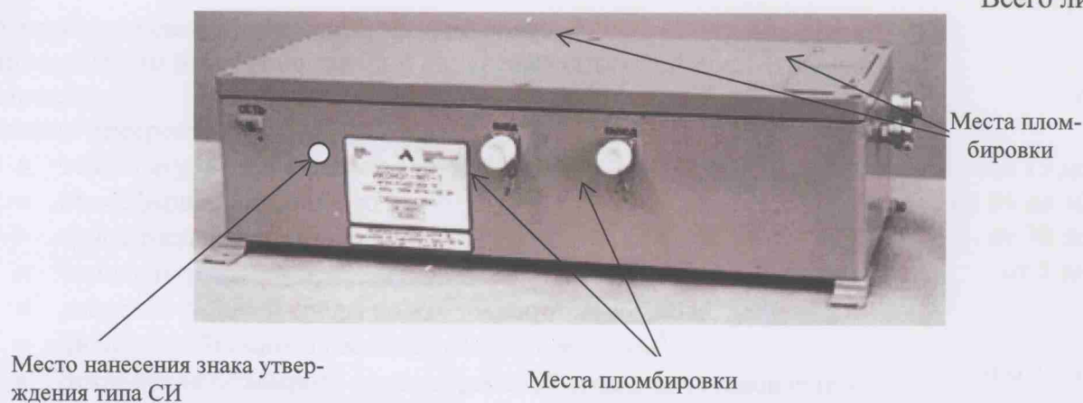
Рисунок 2 - Схема места нанесения знака утверждения типа и мест пломбирования спиртомера
